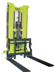
Специальный вилочный погрузчик со свободным подъемом. Мачты триплексной системы с профилями возвышения в “Н” из горячекатаной стали качества ST 52.3 с усиленными осевыми подшипниками.
