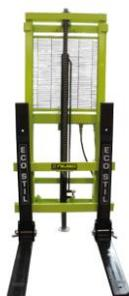
Двухшпindelная система мачт с профилями возвышения из листовой штампованной противоизносной стали собственного производства и собственных пресс-форм со специальными подшипниками с регулировкой покрытия.
