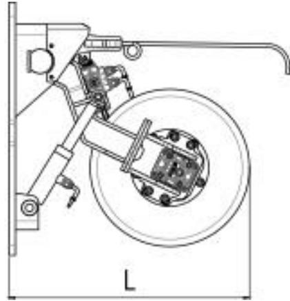
Косящий диск с гидравлическим штоком. Требуемый расход масла 25 л/мин (двигатель) + 12 л/мин (шток).
