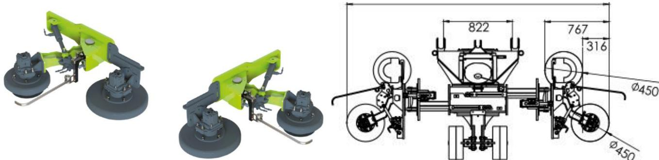
Комплект, состоящий из четырех мотоблоков (по два с каждой стороны), одного неподвижного и одного качающегося с гидравлическим стержнем, которые работают в комбинации, обрабатывая обе области между деревьями и рядом с ними.
