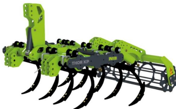
Культиватор для правильной подготовки почвы на виноградниках. Возможность установки промежуточного штока с обеих сторон станка.
