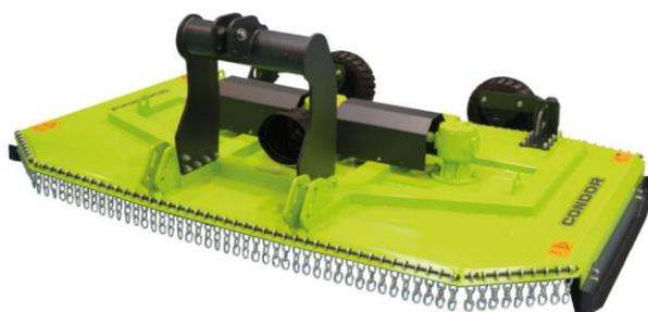
Полуприцепная косилка с двойным ротором для тракторов мощностью от 90 л.с. Подходит для расчистки почвы и посевов, кустарников и легких работ в лесу.
